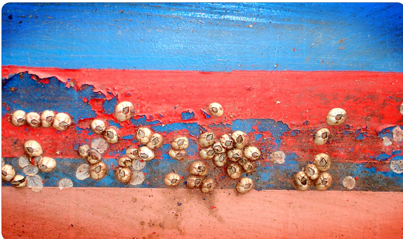
Pąkle na wodnicy nie zabezpieczonej antifoulingiem
