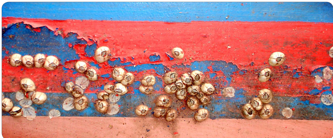
Pąkle na wodnicy nie zabezpieczonej antifoulingiem
