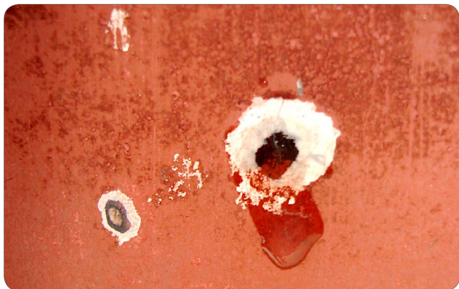
Po zgnieceniu z bąbelka wypływa płyn o charakterystycznym octowym zapachu
