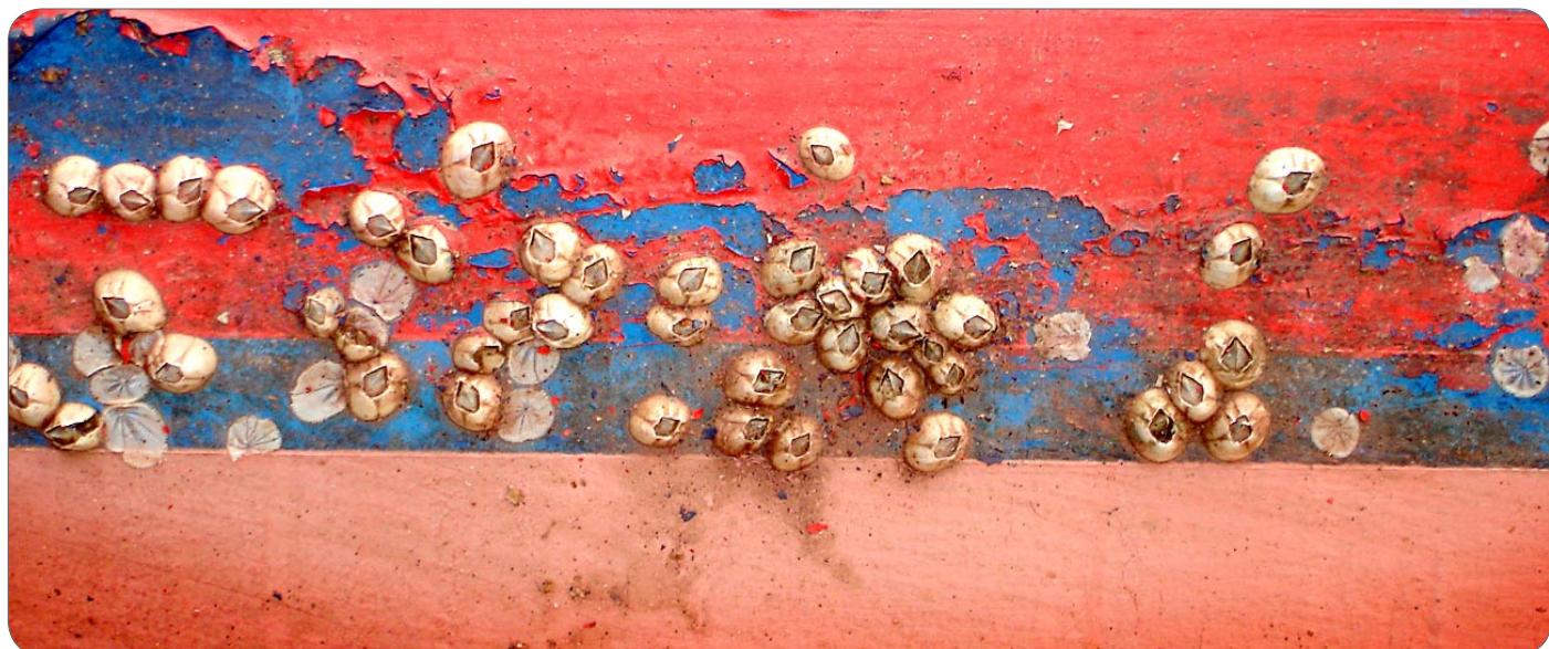
Pąkle na wodnicy nie zabezpieczonej antifoulingiem
