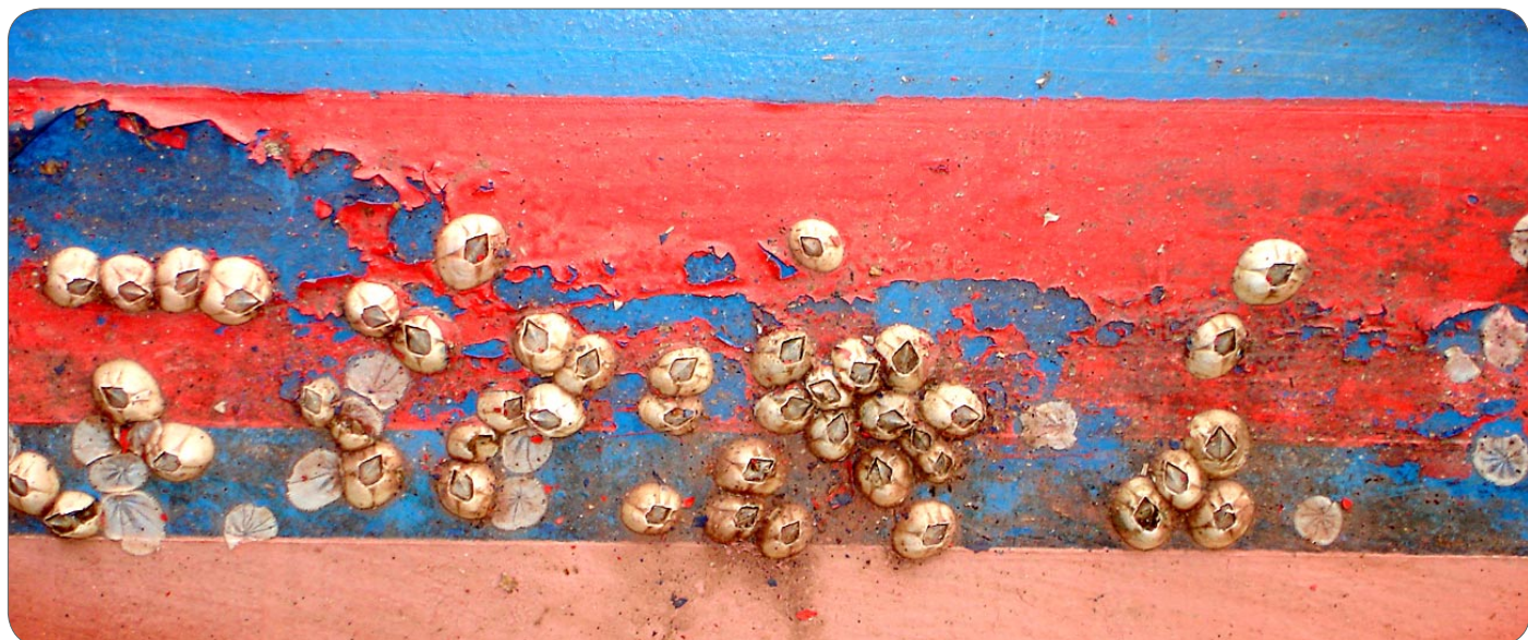
Pąkle na wodnicy nie zabezpieczonej antifoulingiem
